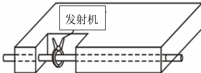
图4.7夹钳耦合法
