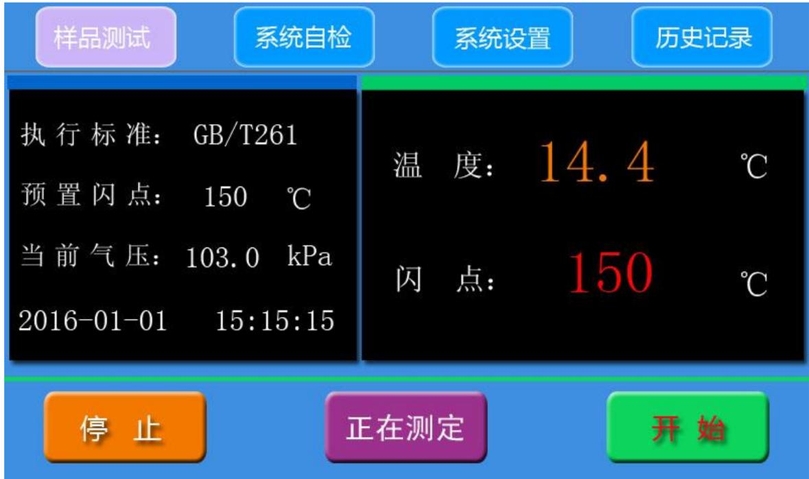
点击“开始”，测试臂落下，开始测试并有一个正在测定的提示图片；
