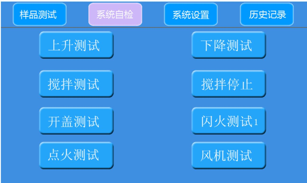
点击“上升测试”，测试臂组件升起；点击“下降测试”，测试臂组件落下。
