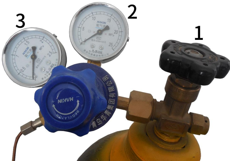
1. 总压阀 2. 总压表 3. 分压表 0.4MPa
