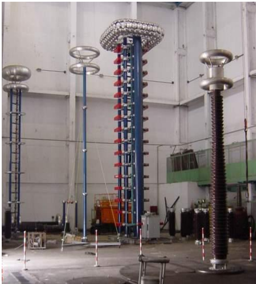
图3 3200kV冲击电压试验系统
